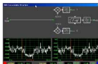
Bild 3: Der Profi-Demodulator zeigt die Arbeitsweise eines Quadraturmischers.
