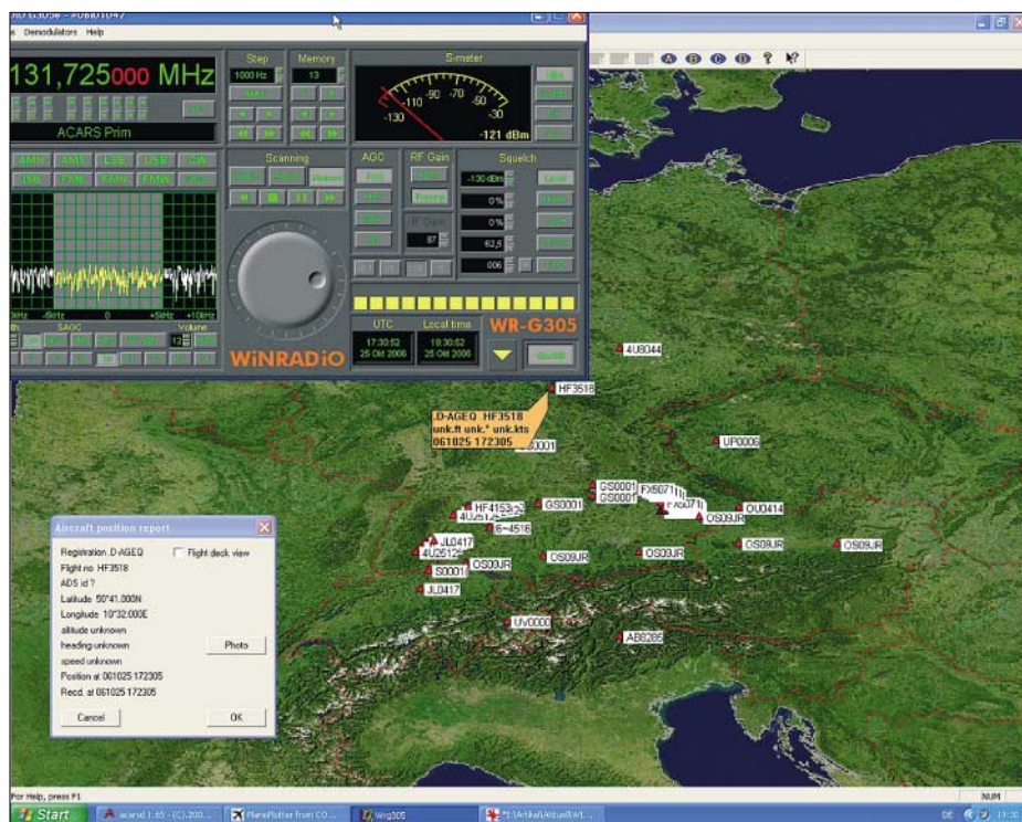
Bild 6: Positionsmeldungen, empfangen vom G305e und decodiert durch „Planespotter“
