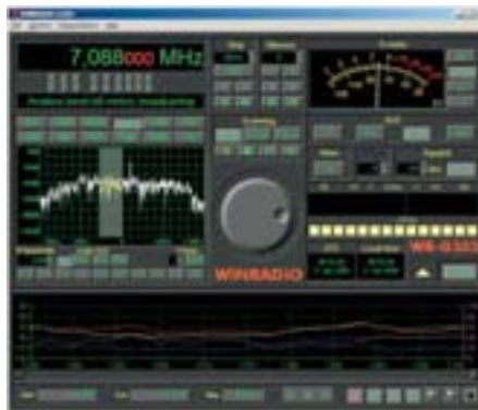
Mit einer zweiten Spektrumsanzeige lassen sich Bandbelegungen grafisch darstellen. Exakte Feldstärke bietet der WR-G303e/PD in dBm-, S- und \mu V-Werten an.
