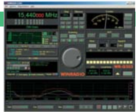
Beim Empfang des digitalen Hörfunks nach dem DRM-Standard wird einer der Vorteile der Software definierten Radios deutlich: Neue Betriebsarten lassen sich einfach per Software nachrüsten. Der DRM-Software-Decoder bietet als Zugaben Notchfilter und Digitalrecorder. Im Grafikdisplay am unteren Bildrand ist das 10 kHz breite DRM-Signal der Deutschen Welle aus Sines zu sehen.
