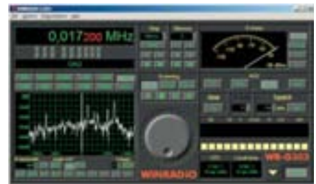
Hohe Empfindlichkeit bis zur Längstwelle: Mit einer geeigneten Antenne empfängt der WR-G303e/PD auch Testsendungen von SAQ auf 17,2 kHz.
