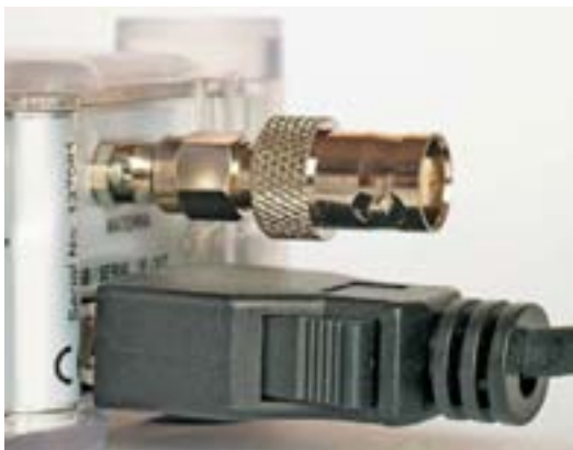
Wohl aus Platzgründen hat der WR-G303e eine für Kurzwellen ungewöhnliche SMA-Antennenbuchse. Einen BNC-Adapter liefert WinRadio mit.
