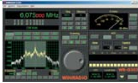
Die Bedienoberfläche des WR-G303e/PD. Alle wichtigen Parameter liegen im direkten Zugriff. Im Spektrumdisplay wird ein 20 kHz breiter Abschnitt rund um die Mittenfrequenz dargestellt. Auch die aktuell gewählte Filterbandbreite ist dort ersichtlich.
